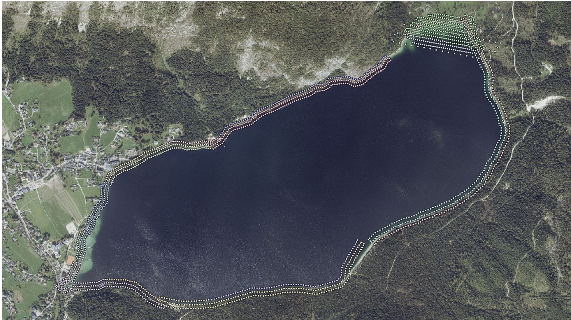
Abbildung 2.3.: Abschnitte und Lage der einzelnen Drohnenaufnahmen, jeder Punkte stellt eine Aufnahmepositionen dar, die Befliegungsabschnitte werden anhand der Punktfarbe unterschieden.
