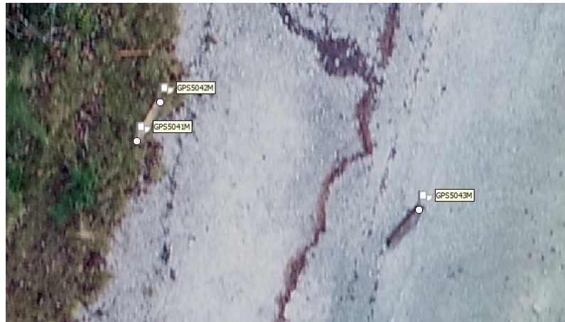
Abbildung 3.7.: Anfänglich nicht eindeutig zuordenbare Passpunkte nach dem Setzen weiterer Passpunkte und mehrmaligem Neuberechnen der Ausrichtung.
