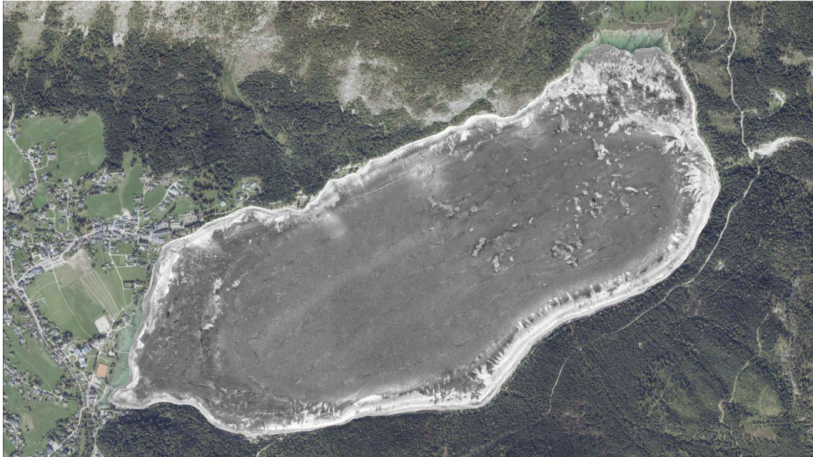
Abbildung 3.29.: Mosaik der Backscatterdaten. Helle Bereiche stellen eine geringe Dämpfung des Echolotsignals dar, vice versa repräsentieren dunkle Bereiche eine starke Dämpfung.
